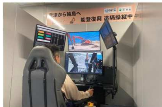
遠隔操縦状況（操縦室内の操縦席）
